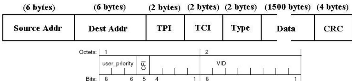
Associare un frame alla VLAN è compito della funzione **ingress**: se un frame ha un tag, la VLAN si legge dai campi specifici. Se non è presente un tag, gli switch managed assegnano la VLAN 0 a tutti i frame non taggati.
