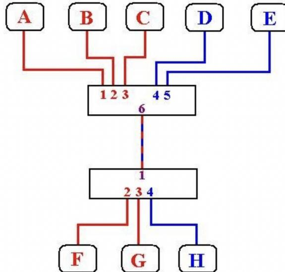
Il link fra i due switch, quando devono comunicare usando più VLAN in modalità tagged, utilizzano un cavo di tipo **trunk**, che trasporta VLAN prefissate (che vengono configurate).
